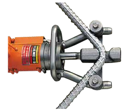
アンカー曲げ
