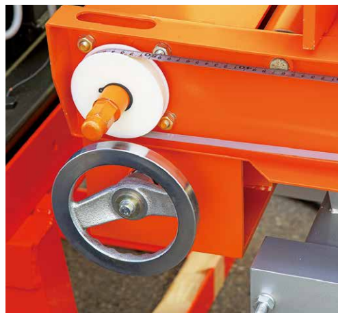
鉄筋寸法を手元で設定
