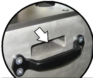
鉄筋屑取り出し用窓
